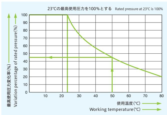
チューブの最高使用圧力は温度の上昇により下降してゆきます。(グラフ参照) 高温流体や高温環境でのご使用時には特にご注意ください。
