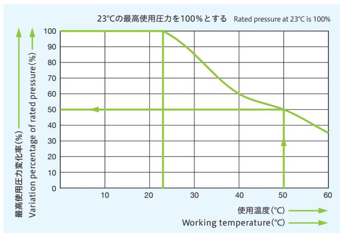
チューブの最高使用圧力は温度の上昇により下降してゆきます。(グラフ参照) 高温流体や高温環境でのご使用時には特にご注意下さい。
